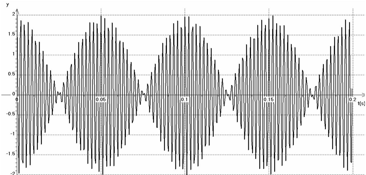
(Courbe tracée sur Regressi pour deux fréquences de 440 Hz et 460 Hz)
